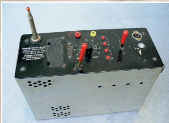
Der schwere aus Stahlblech gefertigte Röhrensender von Stegmaier.
