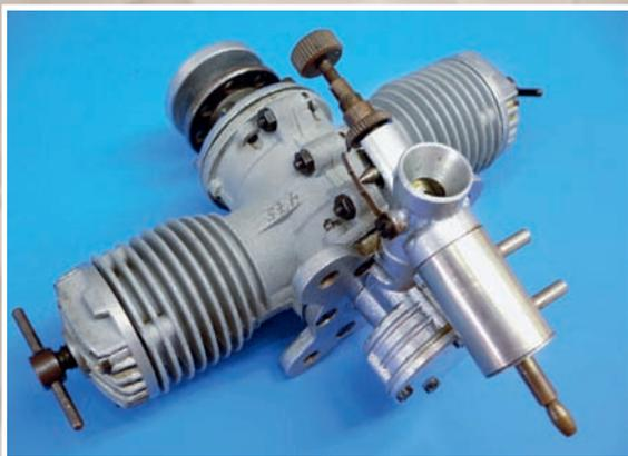
Der von Ruppert konstruierte Webra-Boxer-Diesel mit integrierter Vakuumansteuerung zum Drosseln. Unter dem Vergaser sitzt auf der Kurbelwelle die Unterdruckpumpe.
