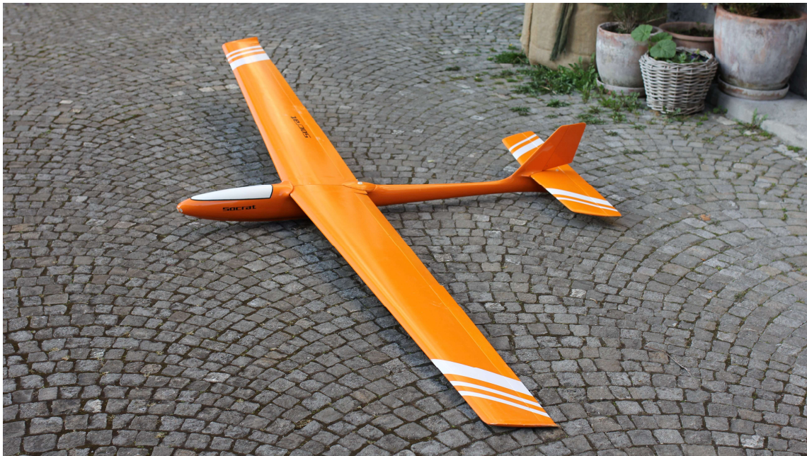
Bild 59: Der Portokali Socrat verfügt über Seiten-, Höhen-, Querruder und Wölbklappen.
