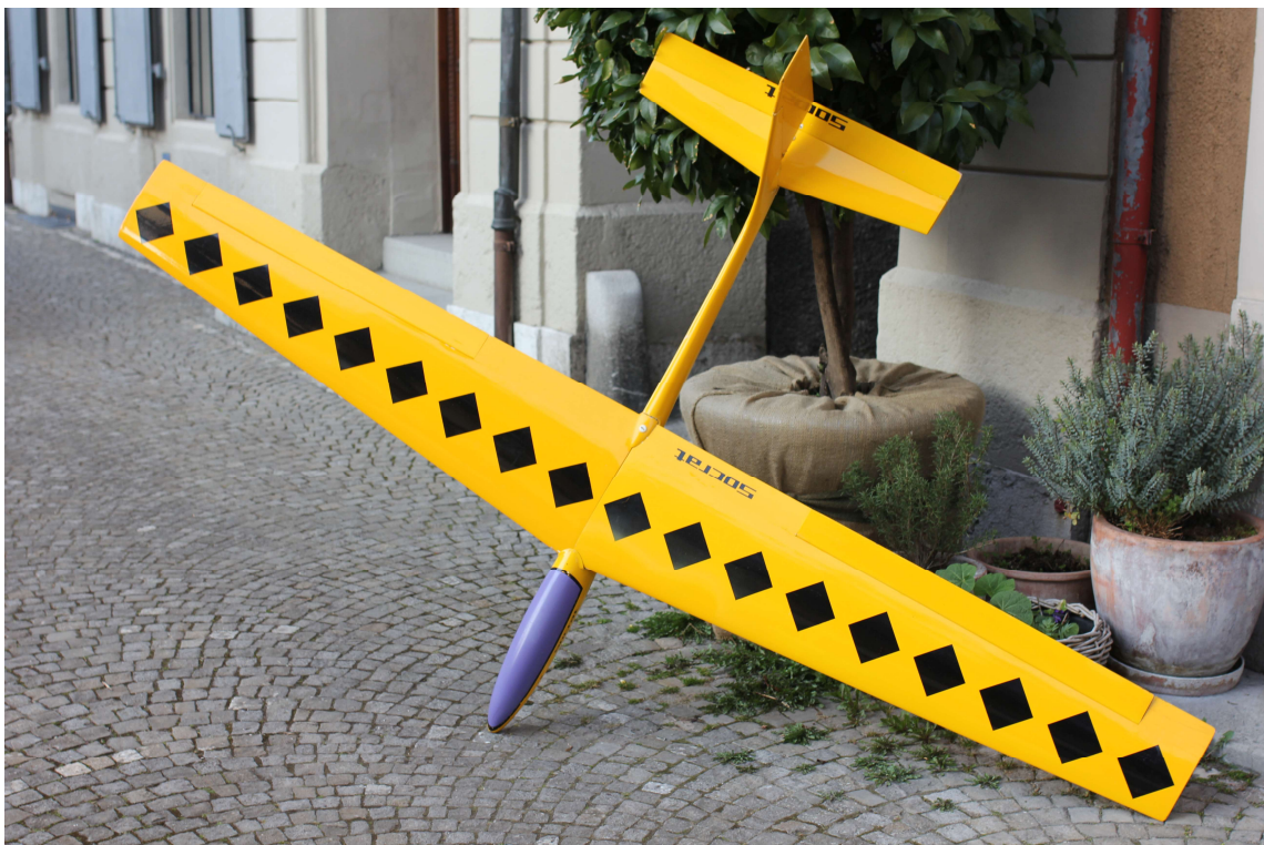
Bild 56: Die Flügeltiefe(breite) beträgt an der Wurzel (Mitte) 33 Zentimeter.
