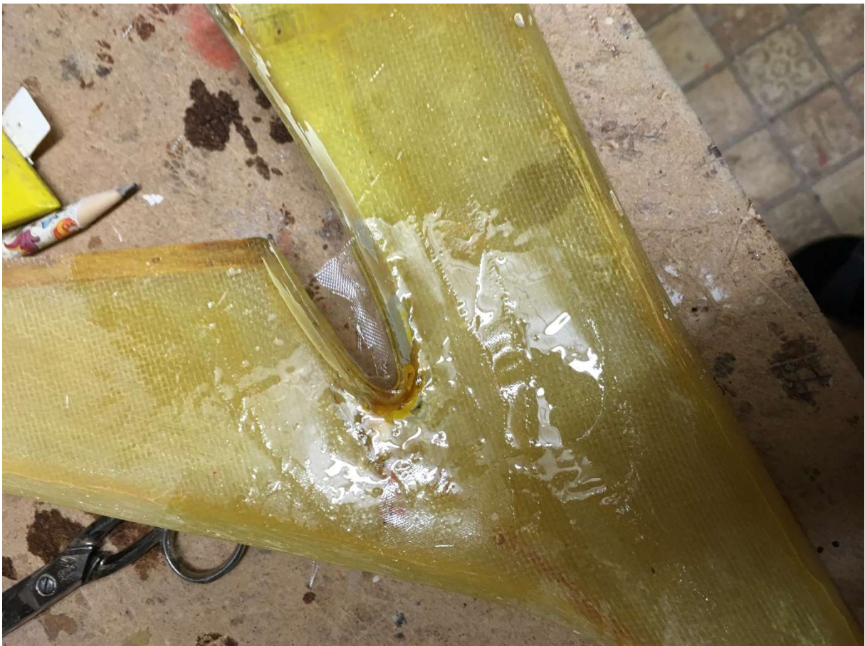
Bild 19: Erster Versuch einer Socrat-Reparatur mit Glasfaser verstärktem Polyester
