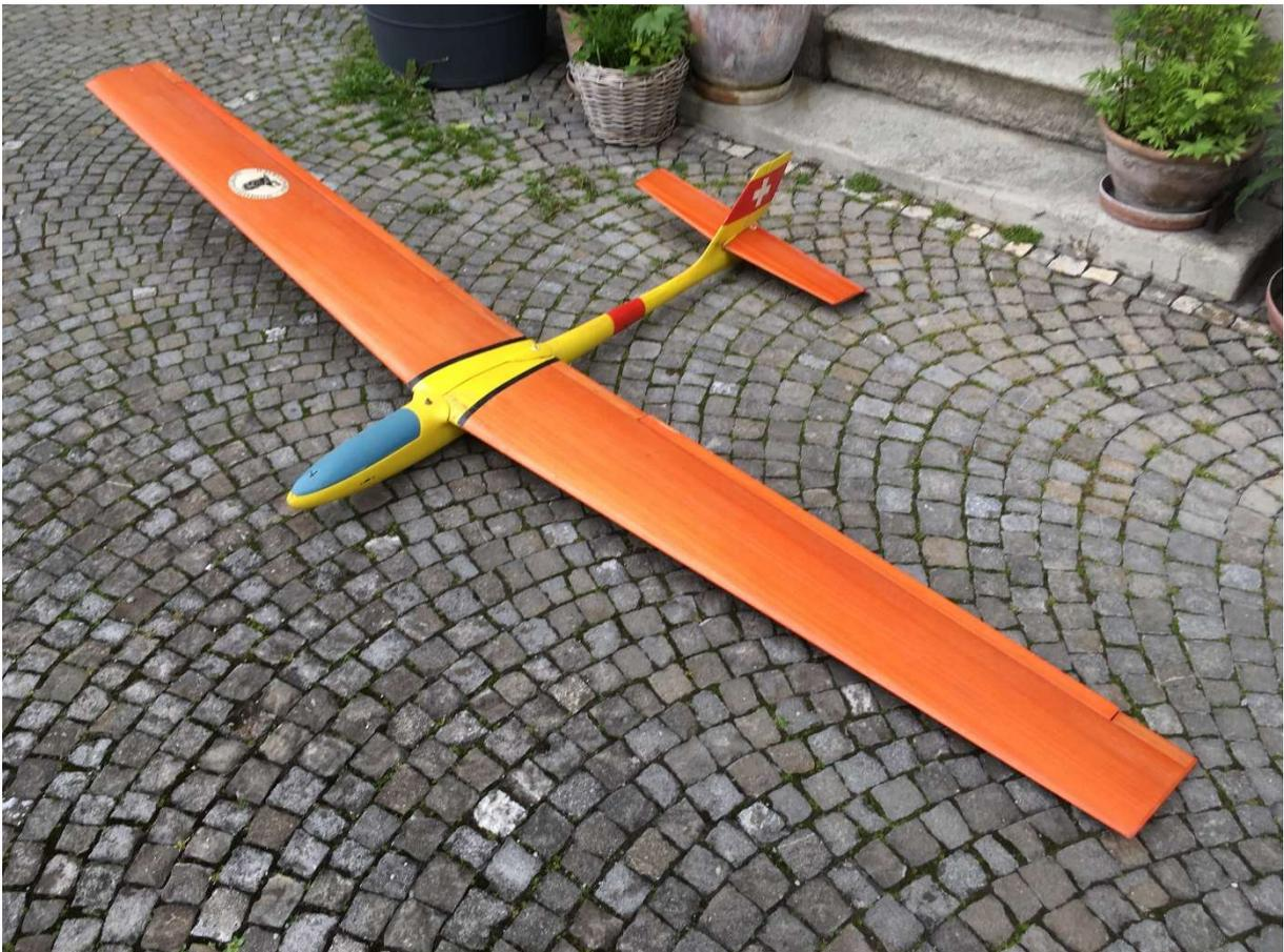
*Bild 08: Querruder-Sokrat mit der korrekten V-Form.*
