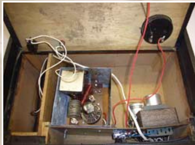
Die Elektronik besteht aus der Gegentaktschaltung mit Oberwellenfilter und dem Zerhacker.
