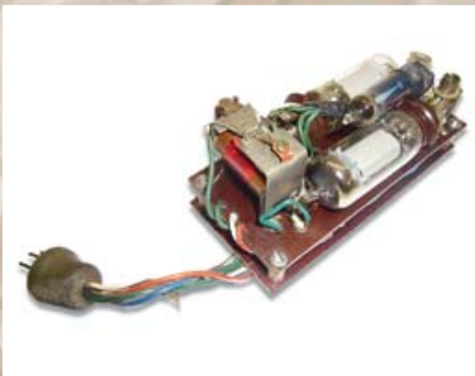
Der erste doppelstöckige Standard-Empfänger von 1954.
