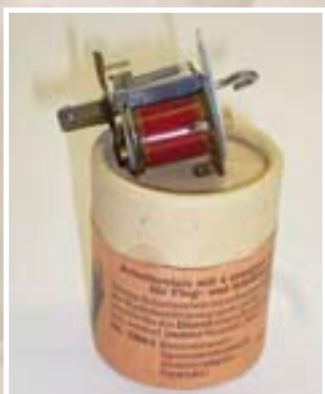
Das Standard-Schrittschaltwerk zur Betätigung der Ruder mit der Originalverpackung.
