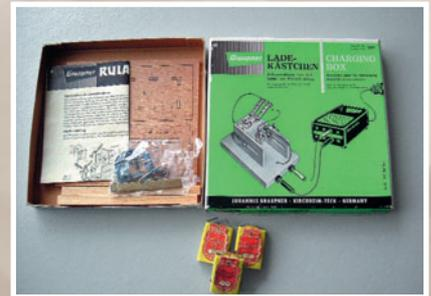
Die erste automatische Abschaltvorrichtung für Akkus kam 1960 auf den Markt. Die Rulag-Akkus dehnten sich gegen das Ende des Ladevorgangs markant aus. Ein mechanischer Schalter überwachte diesen Vorgang und unterbrach den Ladevorgang.
