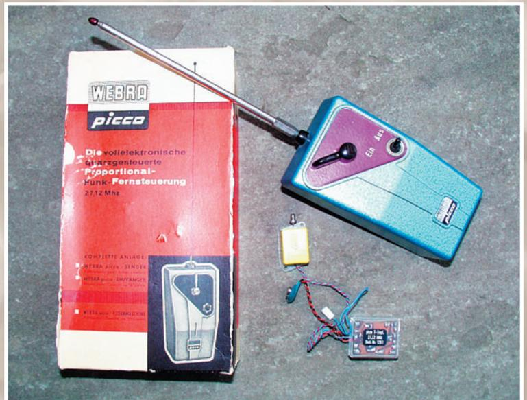
Vollausrüstung für SFR 245.-: 500 Gramm Sender, 30 Gramm Empfänger und 22 Gramm Servo.
