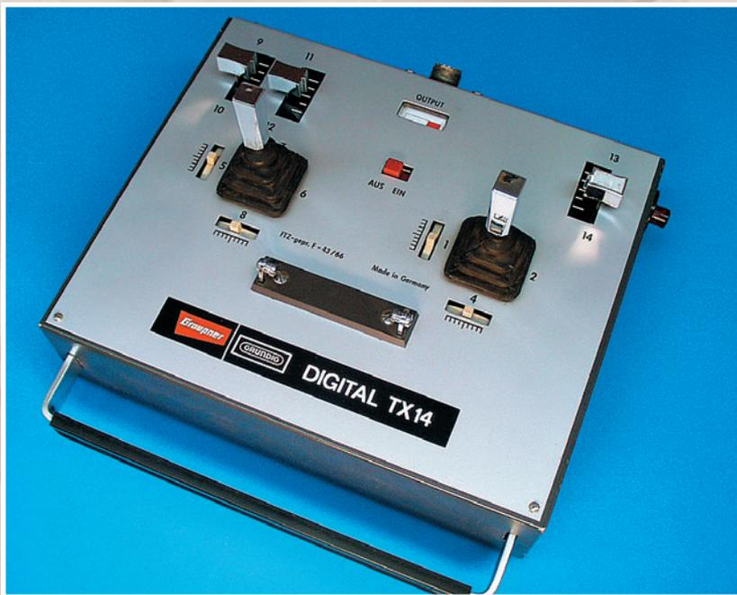
Viele neue Features findet man am Sender: Ausziehbarer Traggriff, Antenne wird im Gehäuse verstaut, und die Knüppelaggregate mit den Gummimanschetten konnten schnell von Mode1 auf Mode2 getauscht werden.
