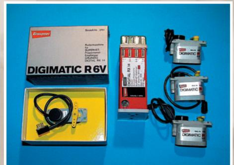
Der DIGITAL-RX-14-Empfänger besteht aus einem Grundbaustein mit 4 Kanälen und einer Ausbaustufe mit 3 Kanälen. 54 Transistoren und 59 Dioden stecken darin. Die Elektronik der Digimatic-Servos befindet sich im Empfänger. Die Servos wurden aus den Spritzgussteilen des alten Tipp-servos Servoautomatic 2 aufgebaut.
