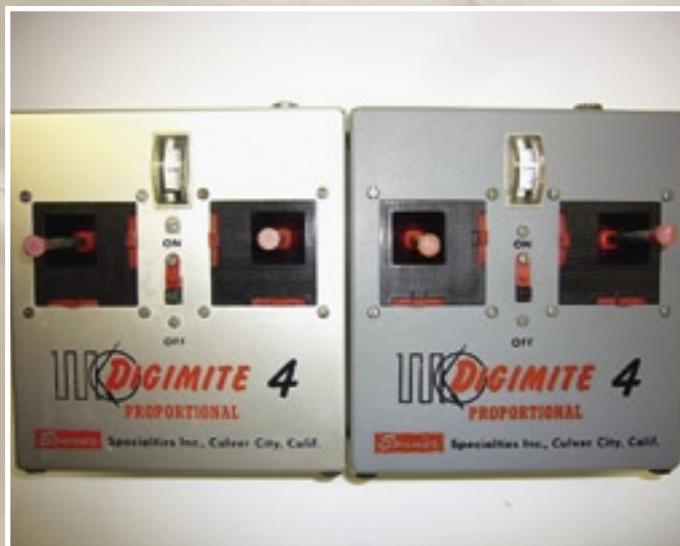
Zwei verschiedene Gehäuse der Digimite 4. Das graue Schrumpflack-Gehäuse war eine spätere Version.
