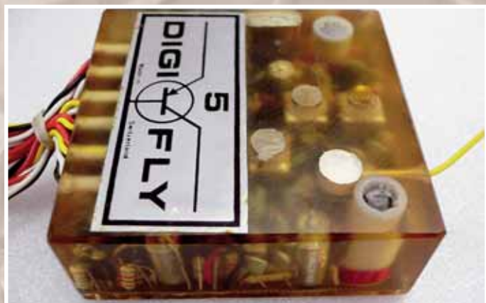
Ebenso legendär: die in Epoxy eingegossenen Empfänger.
